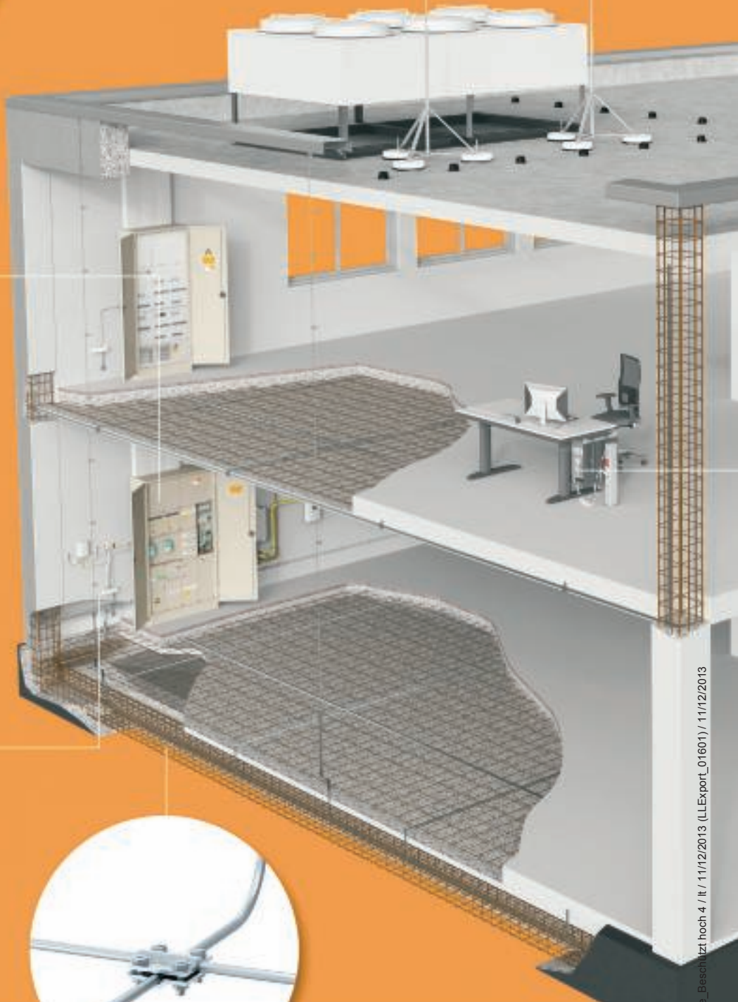
Izoliuota apsaugos nuo žaibo sistema „IsFang“
