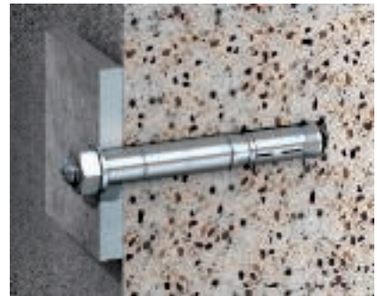
SZ tipo didelių apkrovų ankeris SZ tipo didelių apkrovų ankeris su M12 sriegine jungtimi, skirtas labai apkrautiems komponentams tvirtinti, sertifikuotas naudoti standartiniame trūkusiame arba netrūkusiame betonuose C20/25–C50/60.
