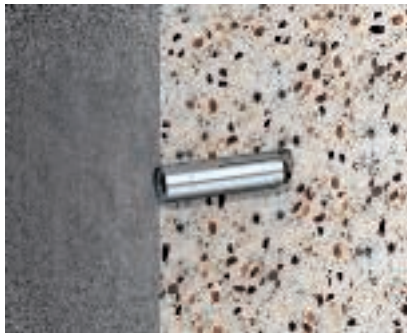
Smūginis ankeris, E tipas E tipo kalami ankeriai M8, M10, M12 vidiniu sriegiu. Pritaikomas mažesnėms apkrovoms nelaikančiose sistemose ir keliataškiame įtrūkusiame ir neištrūkusiame betonuose.
