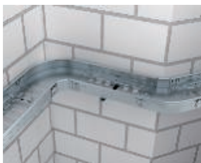
Alkūnės „Magic“ montavimas Fasoninių dalių montavimas, paprasčiausiai įkišant vieną į kitą. Tuo metu kabelių lovelis užfiksuojamas spyruokline puse viršuje į fasoninės dalies jungtį.
