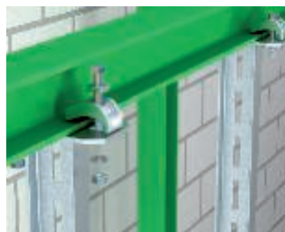
Pakabinimo konstrukcija plienui Didelių atstumų kabelių loveliu tinkama pakabinama konstrukcija naudojantis IS 8 profiliu, pritvirtinu gnybtais prie laikančiosios plieno konstrukcijos.
