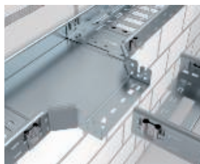
T formos šakotuvo „Magic“ montavimas Fasoninių dalių montavimas, paprasčiausiai įkišant vieną į kitą. Tuo metu kabelių lovelis užfiksuojamas spyruokline puse viršuje į fasoninės dalies jungtį.
