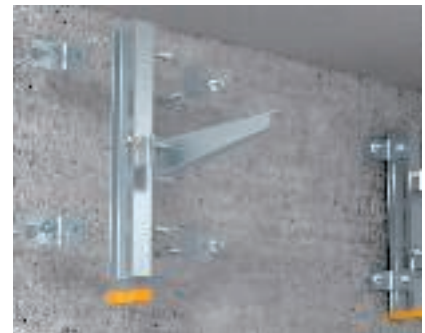
I formos profilio tvirtinimas prie sienos I formos profilio montavimas prie sienos, naudojant BW 80/55 tipo atraminius kampus ir sraiginius ankerius keletui AS tipo atramų, tvirtinamų prie profilių, prijungti.
