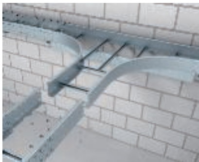
T formos šakotuvo montavimas Alkūnė derinama su didelių atstumų tarp atramų kopėčiomis. T formos šakotuvus jungiamas su kabelių kopėčiomis, naudojant išorinius sujungiklius.
