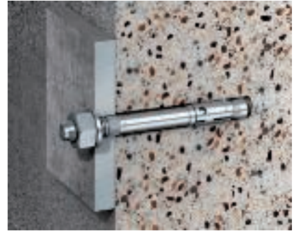
Varžtinis ankeris, BZ tipas BZ tipo varžtiniai ankeriai, skirti didelėms apkrovoms tvirtinti trūkusiame arba netrūkusiame standartiniame betone C20/25–C50/60, tinka montuoti prakišant kiaurai, su jungiamuoju sriegiu M8, M10 arba M12.
