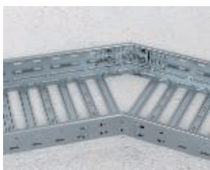
Krypties pakeitimas įpjuvus lovelį kabeliams Supjaustyti loveliai sujungiami kartu iš vidaus, naudojant RWVL.. tipo kampines jungtis.
