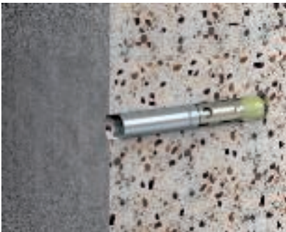
Varžtinis ankeris, BZ-IG tipas BZ-IG ankeris su vidiniu sriegiu skirtas įprastoms, neišgręžtoms skylėms turi statybų reglamento patvirtinimą. Pagal Europos techninį reglamentą ETA-99/0010 trūkinėjantiems ir netrūkinėjantiems betonams, konstrukcinės dalys tvirtinamos ne tik šešiabriauniais varžtais, bet ir varžtais įleistine galvute bei veržlės ir poveržlės sistemomis arba paprastu sriegiuotuuoju strypu.
