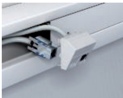
Prietaisų instaliacija duomenų perdavimo lizde Paruoštą duomenų lizdą iš galo įstatykite į atitinkamą plokštelę. Tam į užspaudimo mechanizmą įkiškite modulio laikomąją plokštę ir užfiksuokite.
