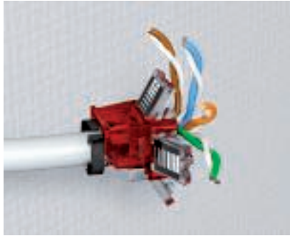
Prietaiso prijungimas - apsauga nuo laidų ištraukimo Uždėkite kabelį ant linijų tiesimo elemento ir įstatykite jį į kabelio laikiklį. Tada pridėdami kabelių dirželiu apsaugokite, kad nebūtų ištrauktas. Jei kabeliai yra ekranuoti, reikia atkreipti dėmesį į tai, kad kontaktinė montavimo plokštė būtų sujungta su ekranu.
