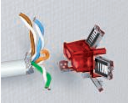
Prietaiso prijungimas – kabelio paruošimas Nuo duomenų kabelio pašalinkite 50 mm ilgio išorinį apdangalą ir ekranavimą.
