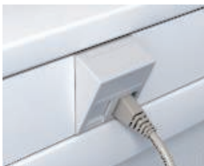
Prietaisų instaliacija sistemos aplinkoje Duomenų perdavimo lizdų laikiklį tiesiog įstatykite į sistemą ir užfiksuokite. Tvirtinimas fiksuojamaisiais elementais tinka ir horizontaliam, ir vertikaliam prietaisų montavimui.
